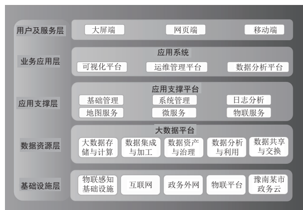
图1 智慧排水管网系统总体架构
