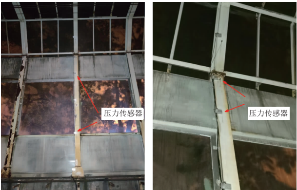
图5 现场测点布置
