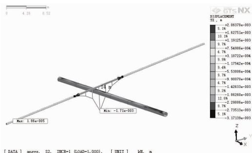
图 12 管线沉降曲线
