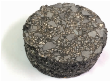
图 1 出水后的旋转压实试件(高强度冷铺沥青混合料)
