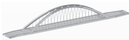
图8 钢箱系杆拱桥有限元模型
