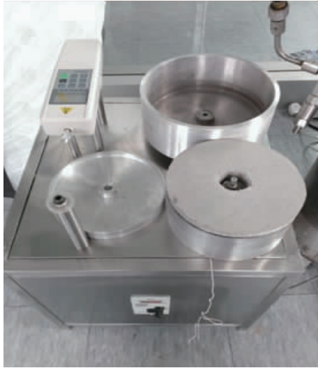
图1 泥浆润滑减阻性能评价装置
