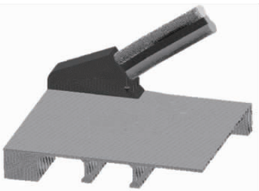
图6 拱脚局部计算模型
