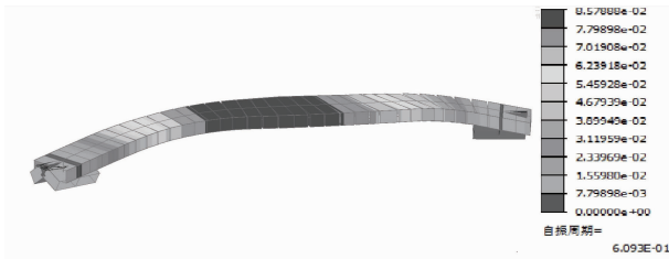
图4 第1阶模态(竖向振动)(单位:kN)
