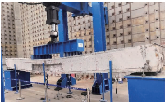
图1 足尺旧空心板破坏试验
