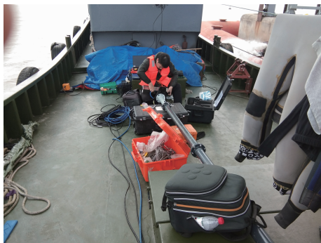
图5 多波束表面声速仪安装
