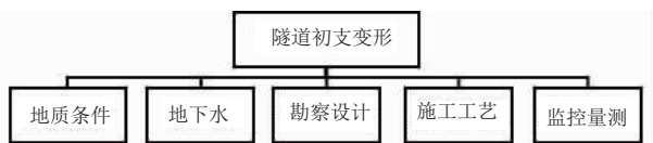
图6 隧道初支变形原因层次分析图
