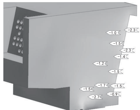
图11 横梁剪应力云图(单位:MPa)
