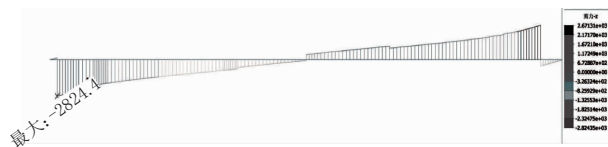
图5 基本组合下主梁剪力包络图(单位:kN)
