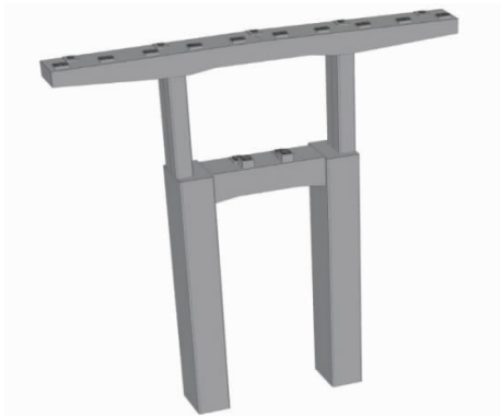
图 2 H 形墩大悬臂变截面盖梁模型图
