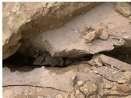
图1 昔格达地层滑移时的层间错动面
