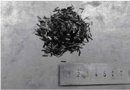
图 1 短切玄武岩纤维(6mm)
