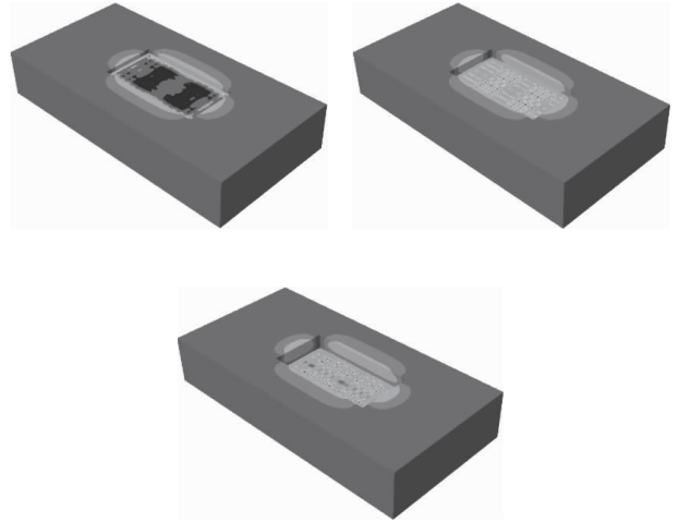
图2 深基坑分布开挖基坑变形
