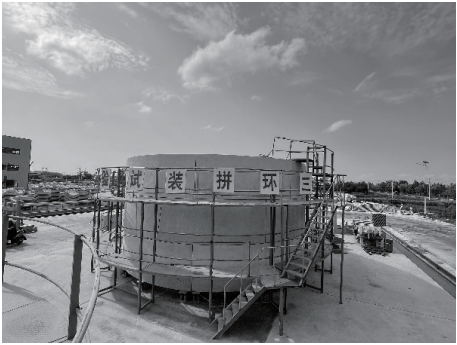
图 7 管片水平试拼装试验
