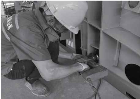
图 3 电动扭矩扳手紧固模具螺栓
