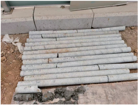
图 4 CFG 桩芯样照片
