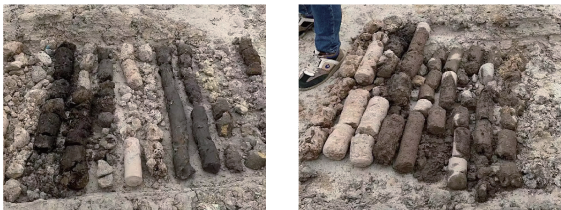
(a)水泥土搅拌桩试桩芯样 3# (b)水泥土搅拌桩试桩芯样 4#
