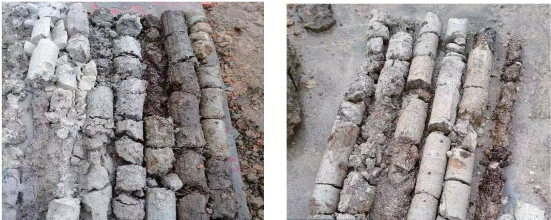
(a)水泥土搅拌桩试桩芯样 1# (b)水泥土搅拌桩试桩芯样 2#
