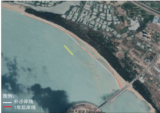
图8 补砂+1座丁坝离岸堤岸滩演变
