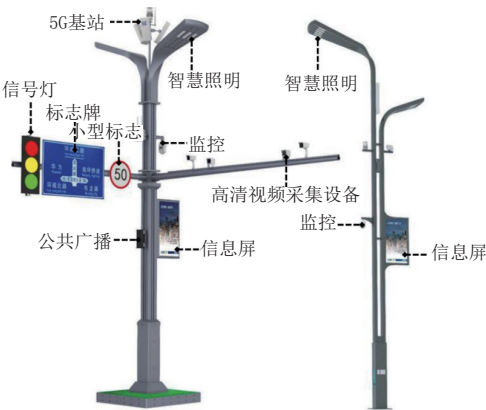
图1 多功能杆与交通信号灯、交通标志牌合杆示意图
