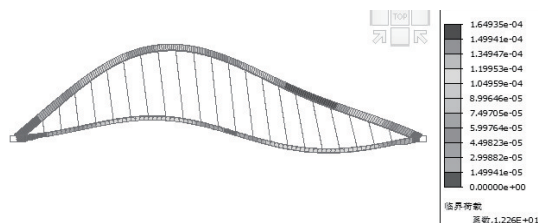
图15 1阶模态,反对称面内失稳( K=12.26 )
