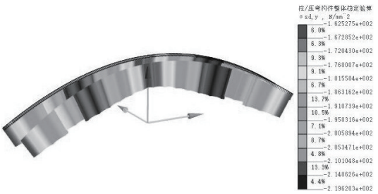
图 11 主拱整体稳定验算应力包络图 (单位: MPa)
