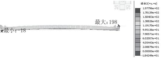
图 12 主梁上翼缘正应力包络图 (单位: MPa)
