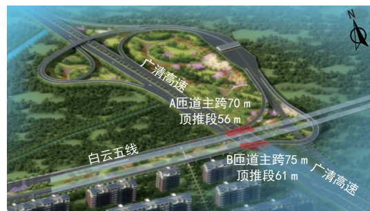
图 1 白云五线上跨广清高速平面图
