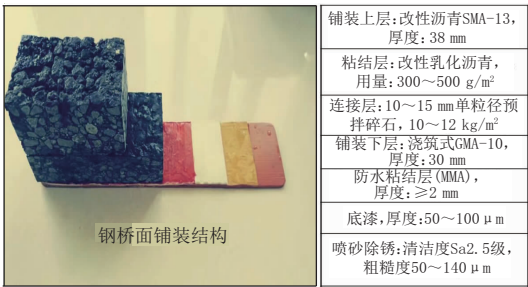
图12 港珠澳大桥钢桥面铺装结构图
