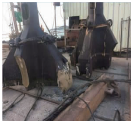
图2 10 t 钻锤缺边掉瓣受损
