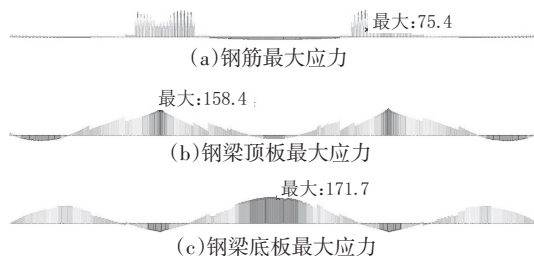
图8 抗裂措施综合应用应力计算结果(单位:MPa)
