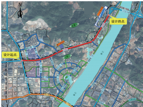
图1 桂柳路综合管廊总平面图
