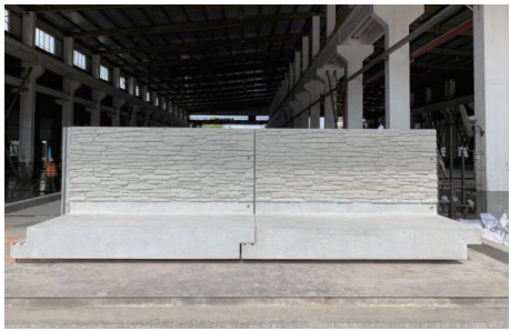
图7 装配式挡墙成品
