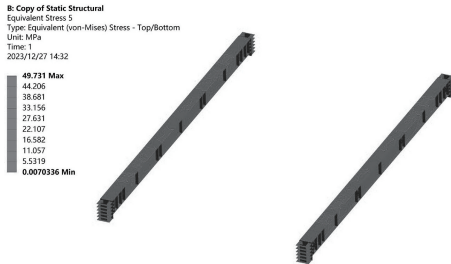
图 18 施工台车底梁应力云图
