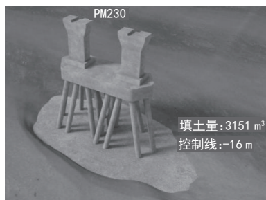
图9 PM230桥墩群桩冲刷坑回填方量计算
