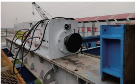
图5 一体化自锁式顶推千斤顶装置
