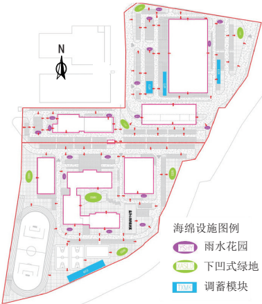
图 5 海绵设施平面布局
