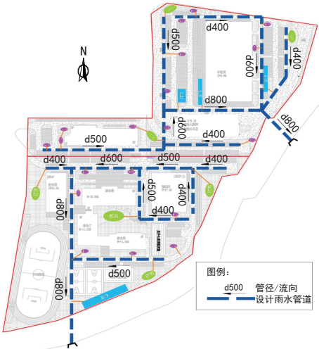
图 6 海绵设施与排水系统的衔接
