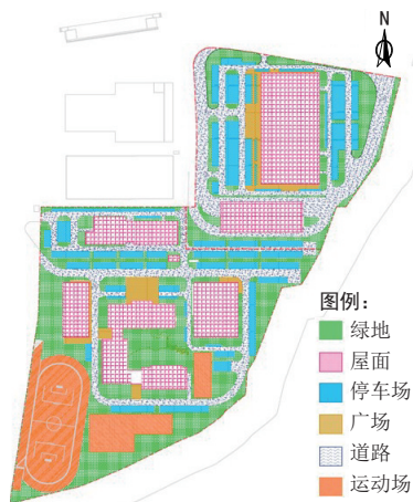
图2 建筑方案场地下垫面分析图
