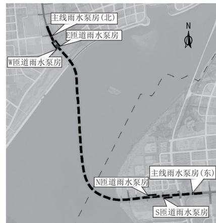
图1 隧道雨水泵房布置图
