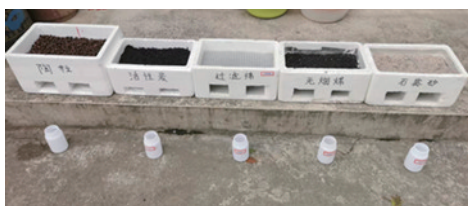
图1 雨水口截污过滤试验装置
