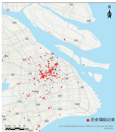
图2 2003—2020年上海市道路地面塌陷事故统计
