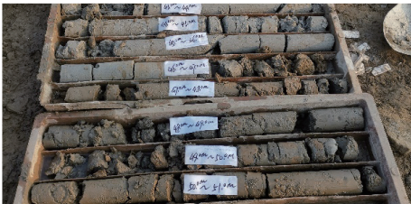
图5 单动管取芯芯样部分照片
