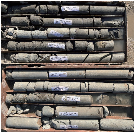
图2 高压旋喷桩龄期15 d芯样图
