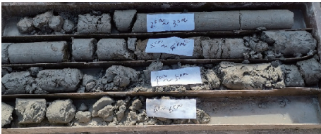
图4 绳索取芯芯样部分照片
