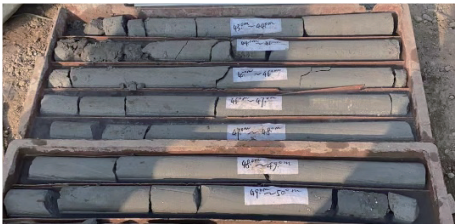
图6 单动三重管取芯芯样部分照片
