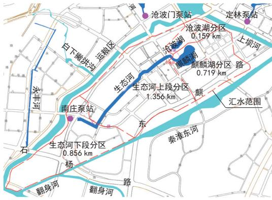
图3 生态河汇水分区平面示意图
