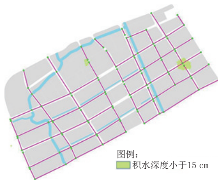
图4 西虹桥区块5 a一遇2 h降雨积水情况
