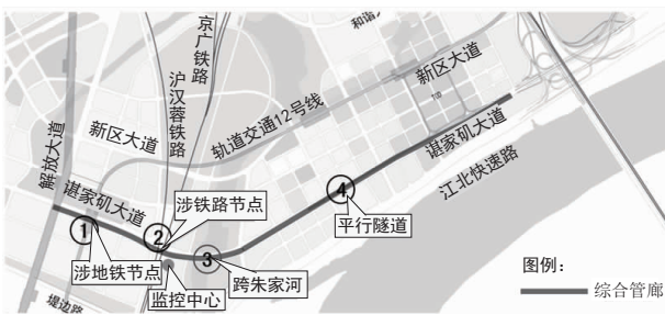
图4 谏家矶大道综合管廊关键节点图
