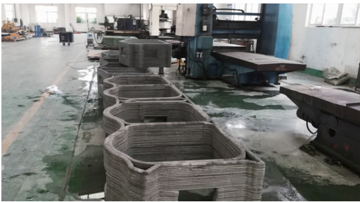
图6 3D 打印预制箱型砌块的生产
