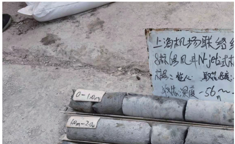
图6 钻孔取芯芯样
