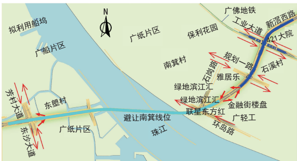
图 8 快捷路二期沉管隧道交通平面图
