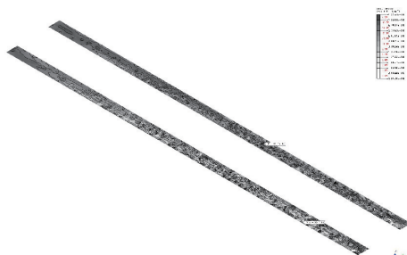
图7 标准组合下顶板 von Mises 应力云图(单位:MPa)
