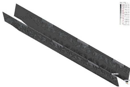
图9 标准组合下腹板 von Mises 应力云图(单位:MPa)
