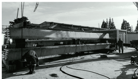
图4 试验梁加载布置过程
