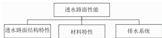
图 1 影响透水路面性能的关键因素
