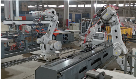
图 10 小箱梁箍筋环自动成型生产线
