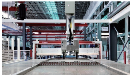
图2 拆模、布模机器人
