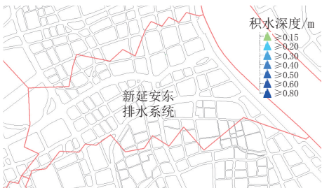
图 6 规划排水系统模拟结果 ( P=5\text{ a} )
