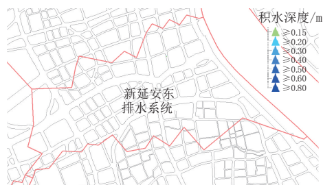
图2 现状排水系统模拟结果( P=1\text{ a} )
