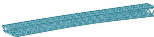
图3 双层钢桁架梁桥有限元分析模型
