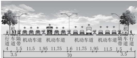
图8 地面快速路段标准横断面(单位:m)
